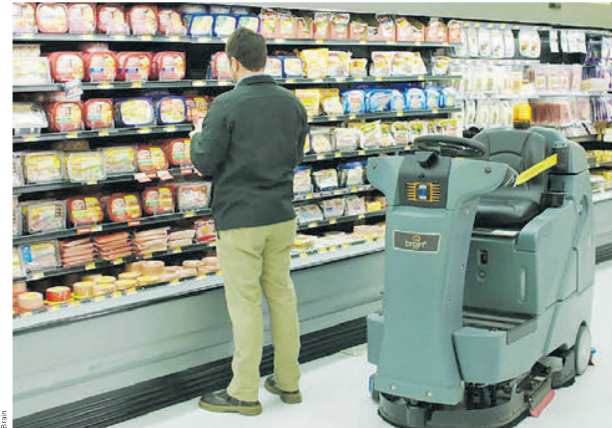
Putzroboter mit Kameras: Regallücken werden für das Bestellsystem erfasst.
